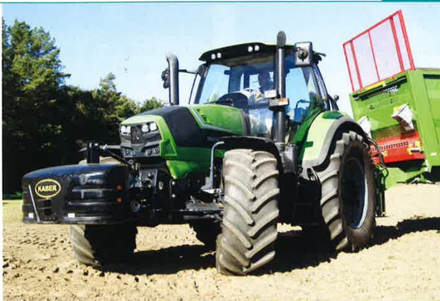
Kąt skrętu kół wynosi 52°, a promień zawracania bez użycia hamulców – 4,95 m.
